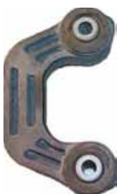
Anneau de fermeture de suspension revu avec l'ajout de gorges destinées à minimiser l'utilisation de matériaux tout en conservant une résistance d'utilisation sûre
