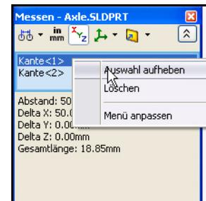
Klicken Sie auf die **Umfangslinie** von Axle<1>. Der Durchmesser beträgt 3 mm.
