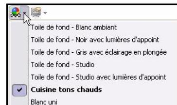
Cliquez sur la flèche déroulante dans l'outil **Réglages de la vue**
