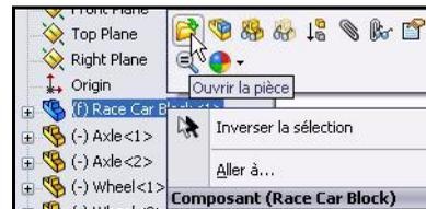
**2 Retourner dans l'assemblage Race Car.**
