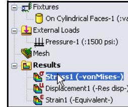
**Remarque :** Les contraintes de von Mises représentent les forces internes exercées dans un corps soumis à des chargements externes pour les matériaux ductiles. Les matériaux industriels sont souvent ductiles.
