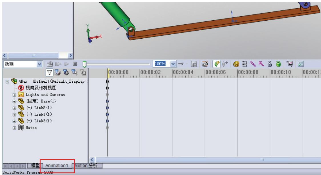
SolidWorks Motion 充分利用了 SolidWorks Animator，因此 SolidWorks Motion Manager 的外观和功能与 SolidWorks Animator 非常相像。
