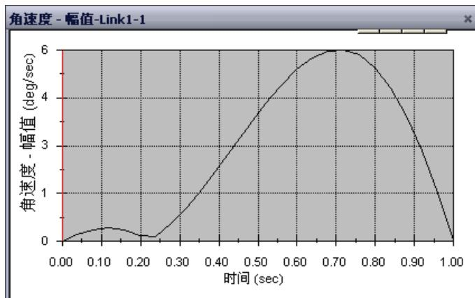
上述图解会显示 Link1 质心的角速度随时间的推移而发生的变化。
