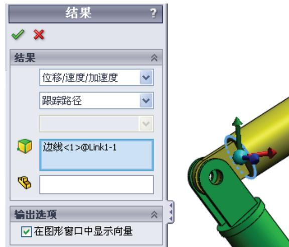
注意，显示的最终轨迹跟踪默认以固定的地面为参照物。要相对于其他运动零部件显示轨迹跟踪，必须在同一个选择字段中将这个参照零部件作为第二个选择项选中。
