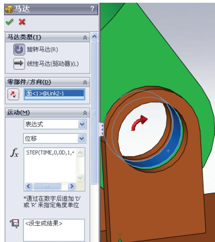
**更多选项**下的最后三个字段用来更改默认的马达位置、指定是否参照其他运动零部件定义此次运动以及指定要用于SolidWorks Simulation 应力分析的载荷力。
