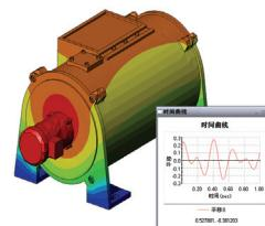
流动模拟可让用户分析零件和装配体周围或内部的运动液体的行为和效果。液体和固体中的热传递情况也会考虑在内。压力和温度效果随后将传送到 SolidWorks Simulation 算例中，以继续应力分析。需要使用此模量回答的典型问题包括：
