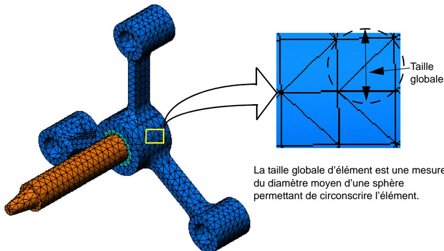
La taille globale d'élément est une mesure du diamètre moyen d'une sphère permettant de circonscrire l'élément.
