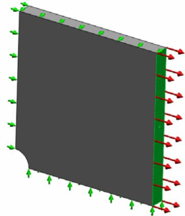
SolidWorks Simulation applique la pression normale à la face sélectionnée et l'icône **Pression-1**
