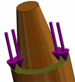
SolidWorks Simulation applique la force à la face sélectionnée et un élément Force-1 apparaît dans le dossier Forces externes.
