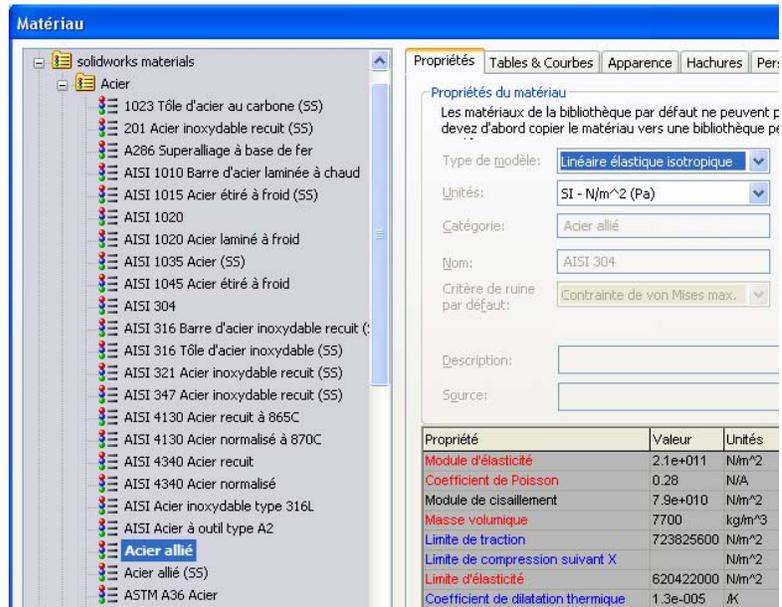
**Remarque :** Les propriétés physiques et mécaniques de l'acier allié apparaissent dans le tableau à droite.
