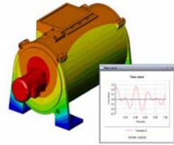
Motion Simulation permet à l'utilisateur d'analyser le comportement cinématique et dynamique des mécanismes. Les forces de liaison et inertielles peuvent ensuite être transférées dans des études SolidWorks Simulation pour poursuivre l'analyse de contraintes. Ce module répond aux questions type suivantes :
