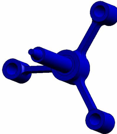
Inspecione o modelo e verifique se há áreas inseguras mostradas em vermelho. Podemos observar que a plotagem não apresenta a cor vermelha, o que indica que todos os locais são seguros.
