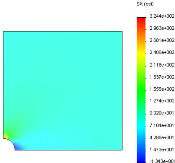
O valor analítico para a tensão máxima normal é  $\sigma_{\text{máx.}} = 302,452$  psi.
