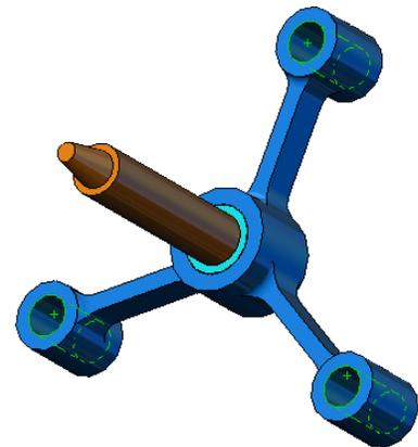
Face<1>, Face<2> e Face<3> são exibidas na caixa **Faces, Arestas, Vértices para acessório de fixação**.
