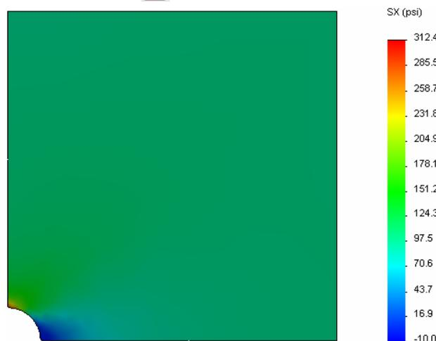
O valor analítico para a tensão máxima normal é  $\sigma_{\text{máx.}} = 302,452$  psi.
