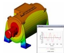
O Motion Simulation permite ao usuário analisar o comportamento cinemático e a dinâmico dos mecanismos. Forças inerciais e forças que atuam nas juntas podem ser subsequentemente transferidas para os estudos do SolidWorks Simulation para continuar com a análise de tensão.
