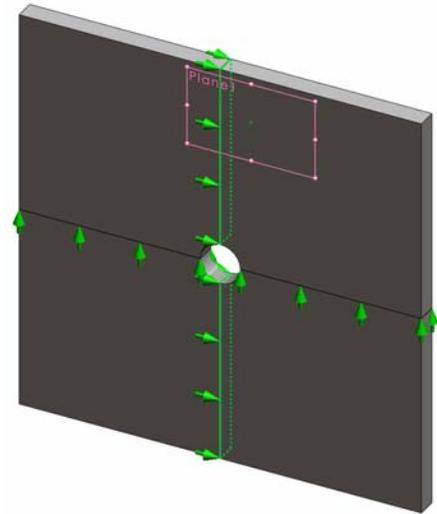
Para impedir o deslocamento do modelo na direção global Z, deve-se definir um acessório de fixação no vértice mostrado na figura abaixo.
