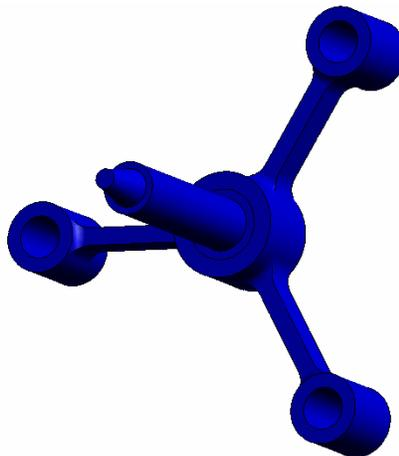
Inspeccione o modelo e verifique se há áreas inseguras mostradas em vermelho. Podemos observar que a plotagem não apresenta a cor vermelha, o que indica que todos os locais são seguros.
