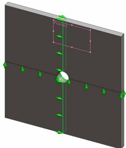
Para evitar el desplazamiento del modelo en la dirección Z global, se debe definir una restricción en el vértice que se muestra en la figura a continuación.
