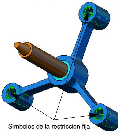
Además, aparece un elemento **Fixture-1** (Pieza fija 1) en la carpeta **Fixtures** (Piezas fijas) del árbol de estudio de Simulation. El nombre de la restricción puede modificarse cuando lo desee.
