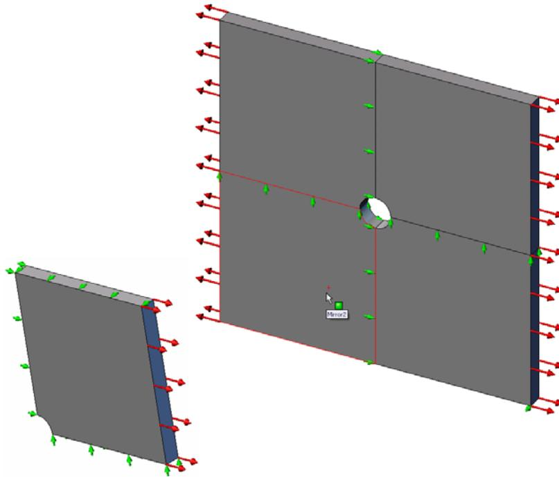
Calculará las tensiones de una chapa cuadrada de 20 pulg. x 20 pulg. x 1 pulg. con un taladro de 1 pulgada de radio en el centro. La chapa está sometida a una presión de tracción de 100 psi.
